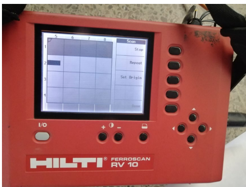
Figura No. 28 Equipo Ferroskan RV10 HILTI
